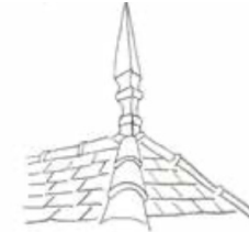
Fig. 9. Épi de faitage Source : A4PLUSA
